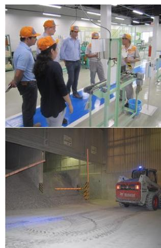
げる取り組みを行っています。たとえば、LWT EMENA、LWT Americas では、フォークリフトの後部に接触事故防止のためのスポットライトを取り付けて照らすことで、バック走行時の死角に歩行者が入り込んで起こる接触事故を防止しています。この取り組みが展開されたLWT Japan では、スポットライトをラインライトに変更し、歩行者がよりライトに気づきやすいようにしています。
