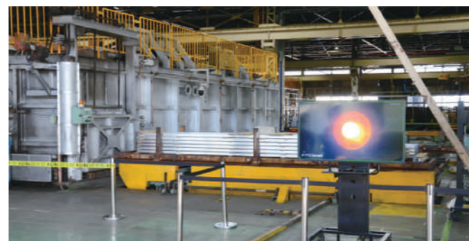
水素燃焼によるアルミ型材のエージング処理
